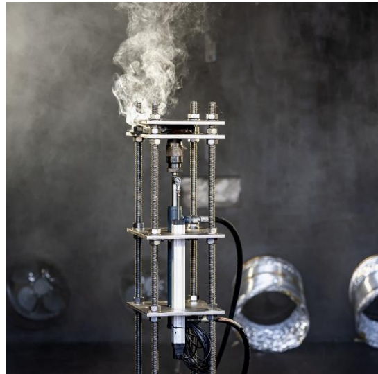
Bild 10: Sicherheitstest: Nageltest für Batterien
